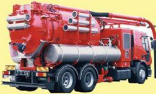
KANAL AÇMA ARACI HİDROLİK TESİSATI
