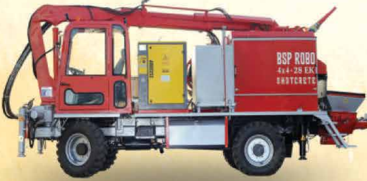
ROBO 4X4 - 28 EKS SHOTCRETE
