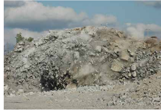
Şekil 2.1 Patlatma sonrası kaya fırlaması
