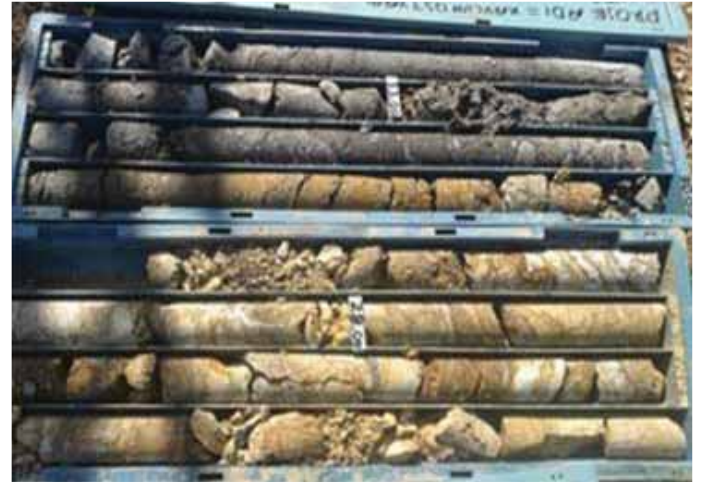
Şekil 2. Metaşist ham madde ocağında yapılan sondajlara ait karot görüntüleri
