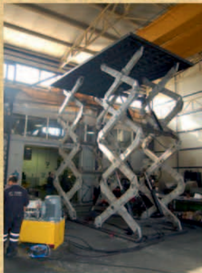
MAKASLI HİDROLİK YÜK ASANSÖRÜ ELEKTRİK RULO MAKARA SİSTEMİ KAPASİTE 500 kg - 3000 kg
