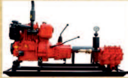
SİLO TEMİZLEME MAKİNASI - HİDROLİK ( 10 METRE ÇAPA KADAR )
