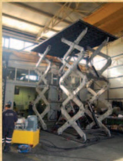
MAKASLI HİDROLİK YÜK ASANSÖRÜ ELEKTRİKLİ RULO MAKARA SİSTEMLİ KAPASİTE 500 kg - 3000 kg
