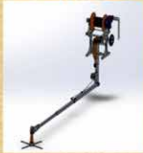
SİLO TEMİZLEME MAKİNASI - HİDROLİK ( 10 METRE ÇAPA KADAR )
